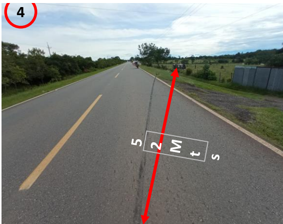
Huella frenada hasta el punto de volcado del vehiculo 52 metros
