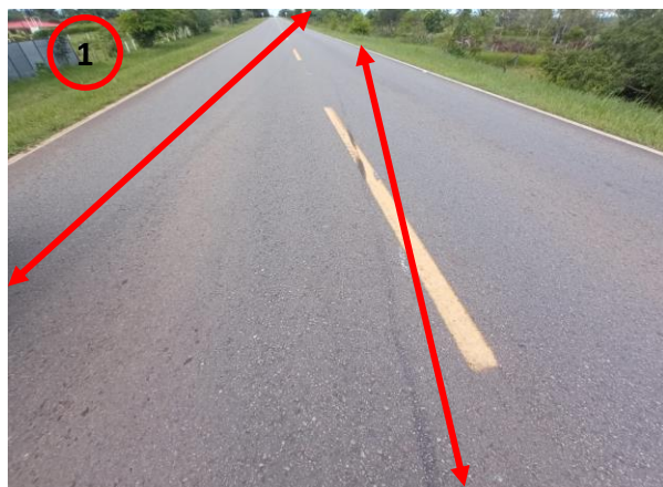
Se observan las dos huellas de frenado del vehiculo
