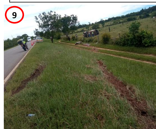
Huella de frenado sobre el terreno tipo pasto.
