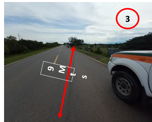
La huella de frenado tiene un longitud de 9 metros.
